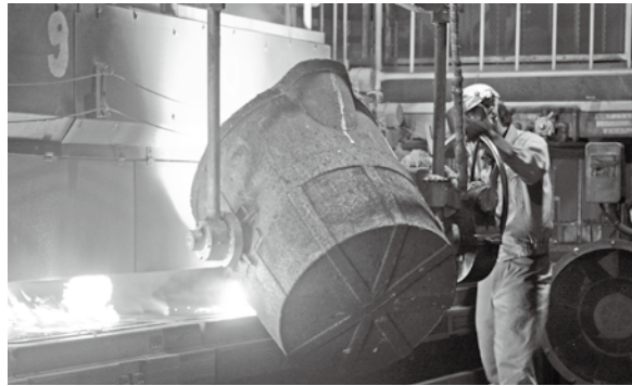
▲約1400℃の金属を砂型に流し込みます
