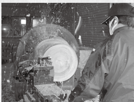
▲臼の底面を削り、厚さを調整
